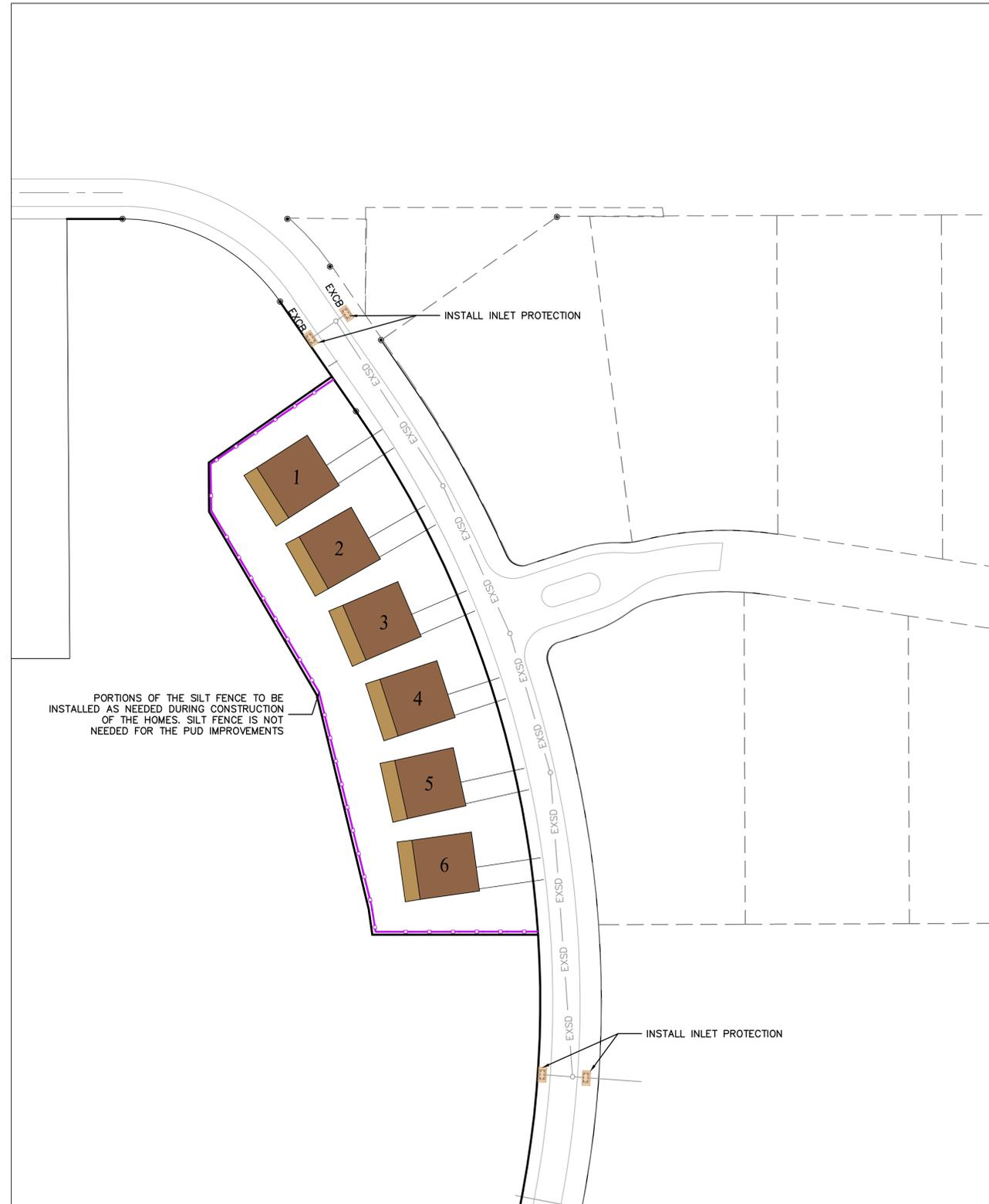
**EROSION CONTROL FOR STORM DRAIN SYSTEM**
